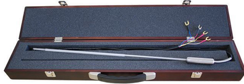
Figura 2.5: La sonda de un termómetro de resistencia de Pt comercial (AccuMac)
